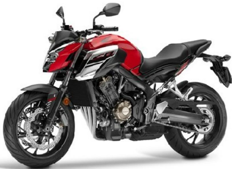
***Honda hat sein Vierzylinder-Naked-Bike überarbeitet. 4 PS mehr Leistung, klangvolles Ansaugeräusch, neue Showa Dual Bending Valve-Gabel und modifizierte Nissin-Bremszangen kennzeichnen den Modelljahrgang 2017. Styling-Retuschen unterstreichen den markanten Auftritt. Highlight des stylisch reduzierten Bikes ist der kompromisslose, noch durchzugsstärkere Motor.***
